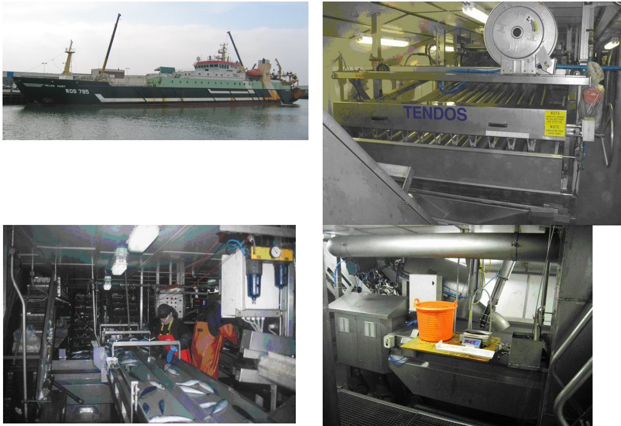
Abb.13: oben links: Freezer trawler von 85m Länge, rechts: Größensortieranlage unten links: Verarbeitungsdeck, rechts: Arbeitsplatz des Beprobbers (© Thünen-Institut/Kay Panten)
