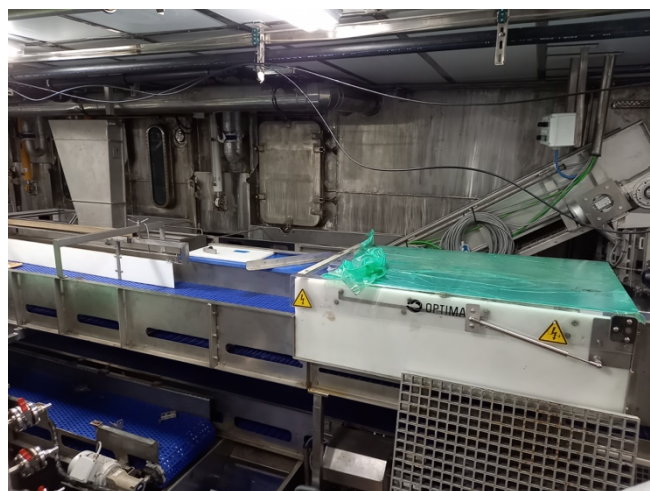
Abb.15: Elektrobetäubungsgerät der Firma Optimar auf der „Jan Maria“, hier noch mit grüner Schutzfolie abgedeckt (© Thünen-Institut/Kay Panten)
