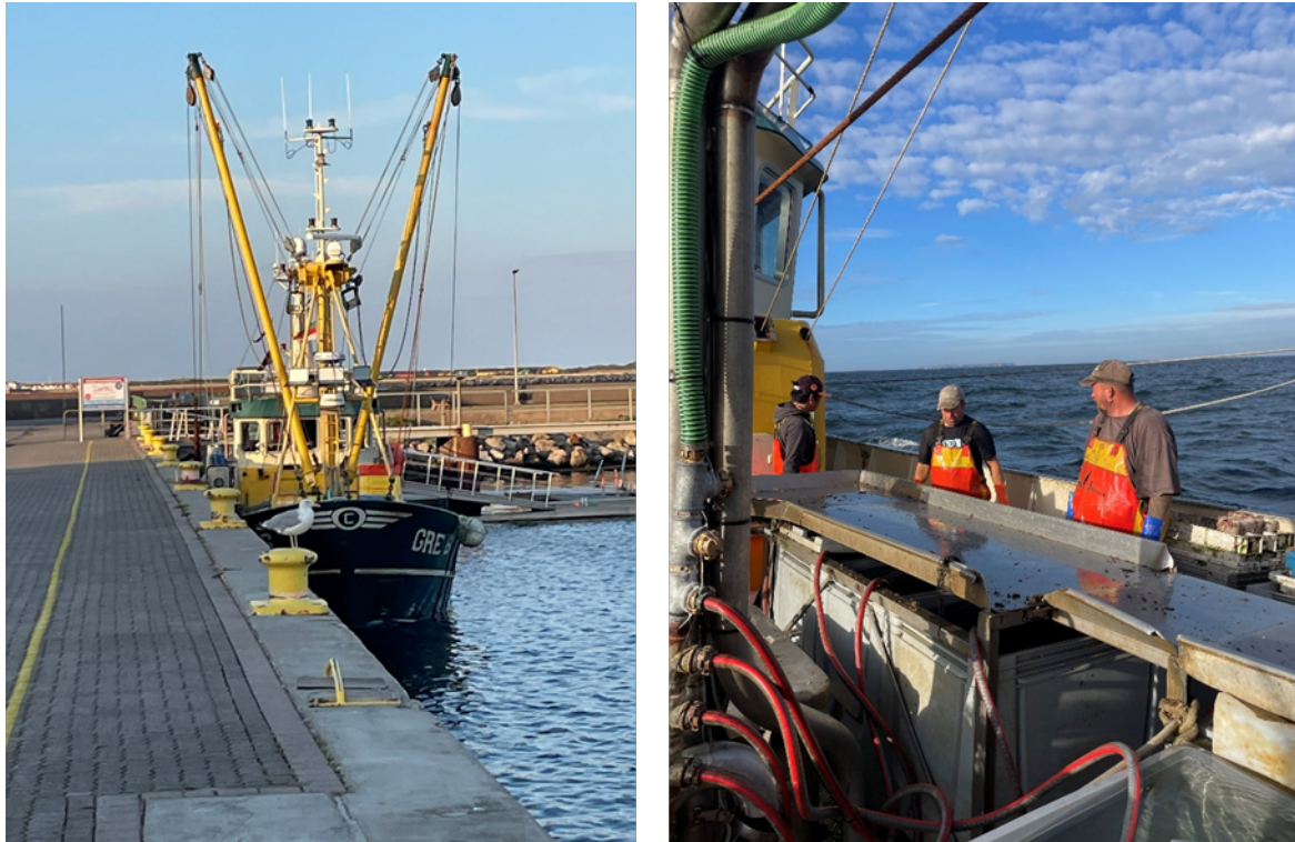
Abb.10: Zur Korbfisherei umgerüsteter Krabbenkutter ALBATROSS (links) mit Verarbeitungsstraße an Deck (rechts) (© Thünen-Institut/Erik Sulanke)
