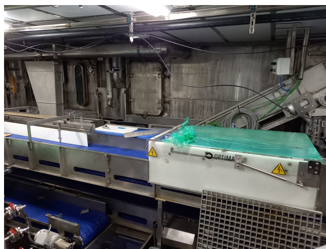
Abb.Fig.15: Elektrobetäubungsgerät der Firma Optimar auf der „Jan Maria“, hier noch mit grüner Schutzfolie abgedeckt / Electrical stunning device from Optimar on the "Jan Maria," still covered with green protective film (© Thünen-Institut/Kay Panten)
