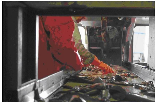
Abb./Fig. 2: Kutter mit Verarbeitungsfließbändern, Fließband an Deck und unter der Back / Cutters with processing conveyor belts, conveyor belt on deck and under the galley (© Thünen-Institut)
