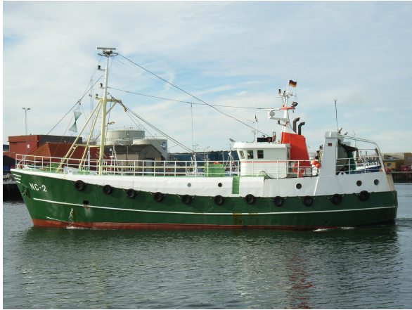
Abb./Fig. 4: Kutter ohne Verarbeitungsstraßen, Gesamtbild und Blick auf das Arbeitsdeck / Cutter without processing lines, overall view and view of the working deck (© Thünen-Institut/Sakis Kroupis)
