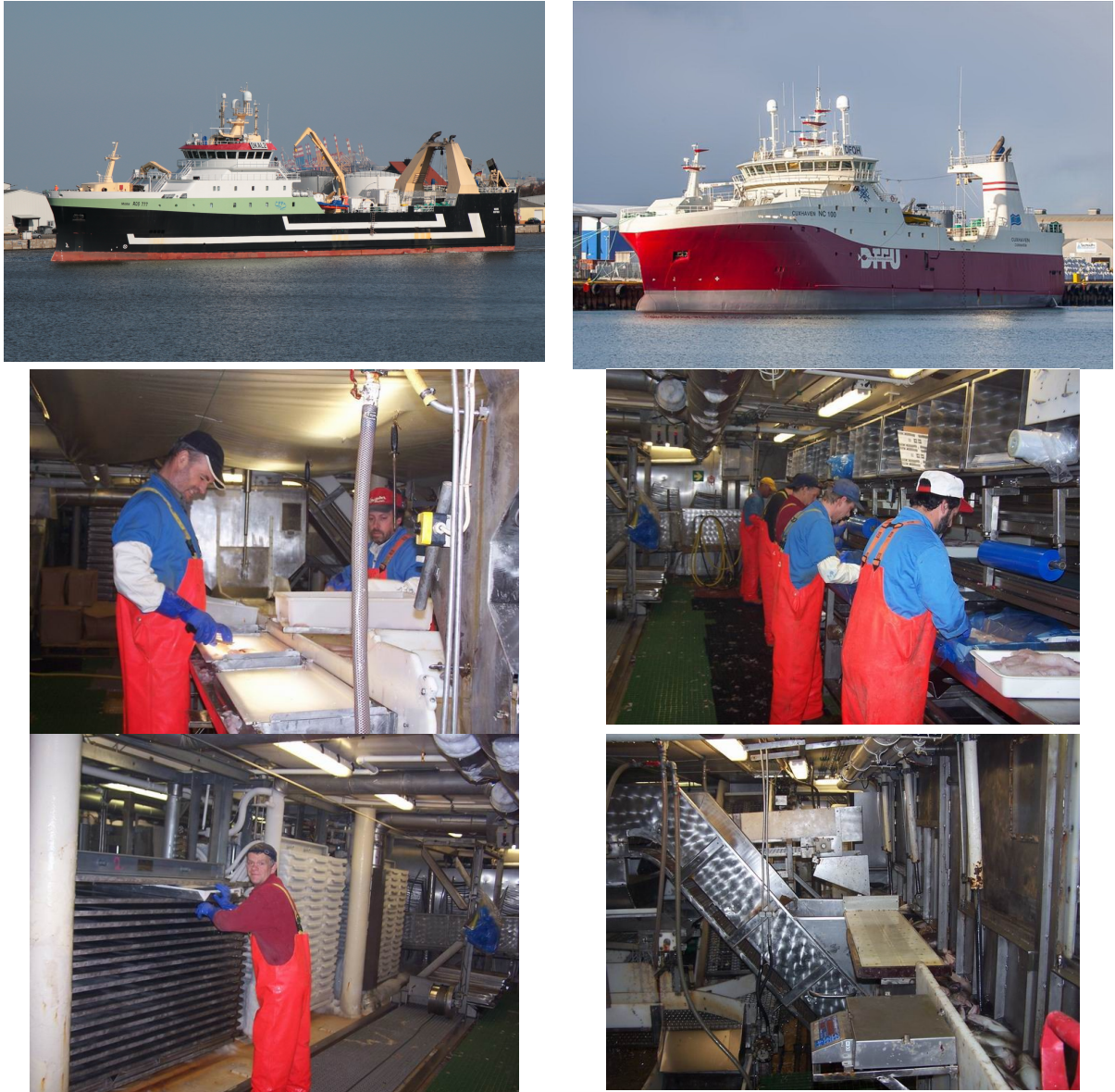
Abb./Fig.14:oben: Gesamtansichten, Mitte links: Qualitätskontrolle, rechts: Portionieren der Filetplatten unten links: Frosten der Filetplatten, rechts: Arbeitsplatz des Beobachters / Top: Overall views, middle left: Quality control, right: Portioning the fillet plates bottom left: Freezing the fillet plates, right: observer's workplace (© Thünen-Institut/Kay Panten, Dietmar Pietschok)
