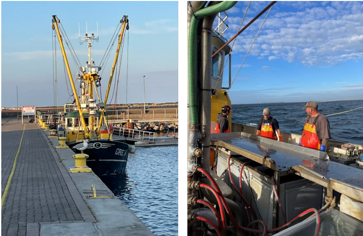
Abb./Fig. 10: Zur Korbfisherei umgerüsteter Krabbenkutter (links) mit Verarbeitungsstraße an Deck (rechts) / A shrimp trawler (left), converted for pot fishing, with processing line on deck (right) (© Thünen-Institut/Erik Sulanke)
